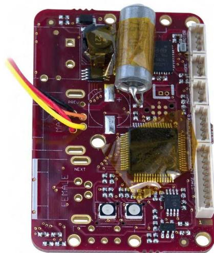
図 4：高真空対応の PCB
