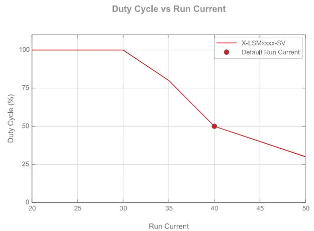
図 6：X-LSM-SV の稼働電流対デューティサイクルのプロット。
