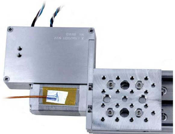
図 7：モータに取り付けられた K タイプ熱電対
