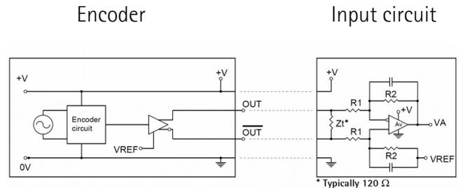
$$V_{REF} = 2.5V \pm 0.5V \quad V_A = 1V_{pp} * A_v \quad A_v = R2/R1$$
